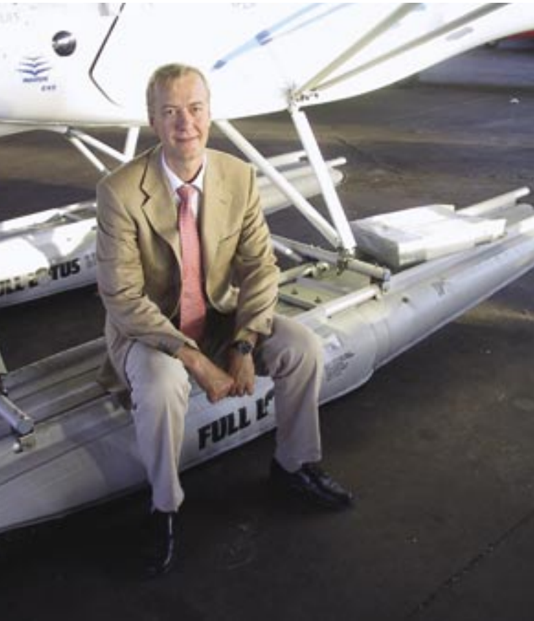
Jukka Sulku nykyaikaisen kevytkoneen kellukkeella. Kelluke on täytetty ilmalla autonrenkaan tapaan. Kevyen koneen alla se kestää melkoisia rasituksia.
